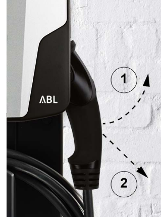
Latausliittimen poistaminen EVSE 8X3 -mallissa (vastaavanlainen kuva)
